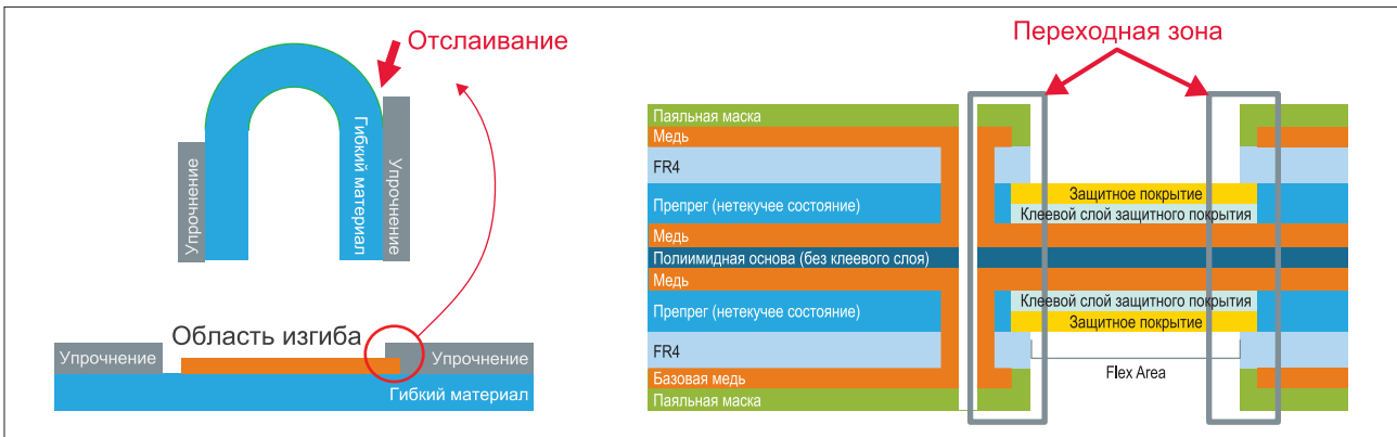
Рис. 3. Область перегиба и переходная зона на гибко-жестких платах
