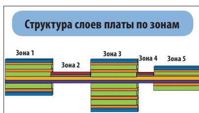
Рис. 1. Структура гибко-жесткой платы с разбиением на зоны
