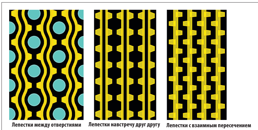
Рис. 7. Примеры лепестковой трассировки скоростных сигналов
