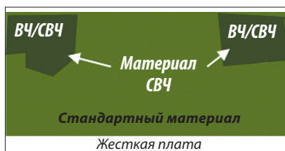
Рис. 2. Вставки СВЧ-материала в многослойной плате
