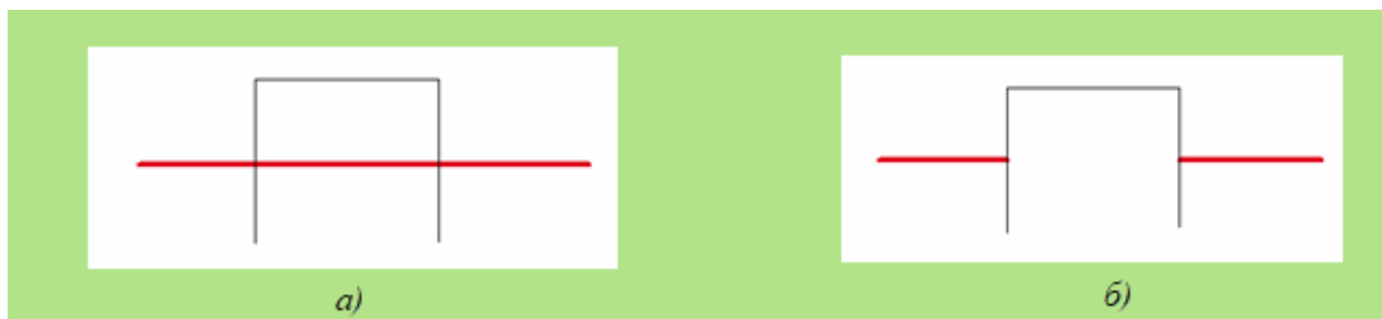
Рис. 3.10 Пример обрезки сегмента (красная толстая линия) с помощью полилинии: а) – размещение границы обрезки (черная тонкая линия); б) – результат обрезки
