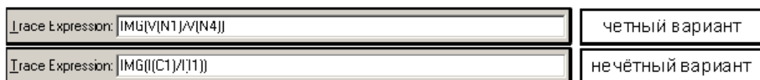
Рис. 31. Ввод выражений для мнимой части комплексного коэффициента передачи в строку Trace Expression окна Add Traces
