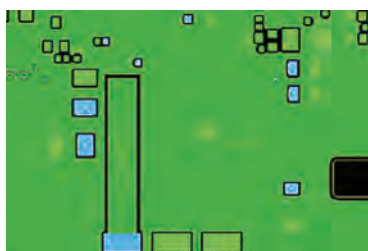
Сдвиг сегмента границы контура полигона. Сегмент выделяется двумя кликами мыши
